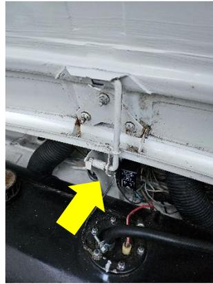
Zum Tanken den Tankdeckel (roter Pfeil) gegen den Uhrzeiger-Sinn drehen und öffnen. Zum Verschließen Tankdeckel im Uhrzeiger-Sinn drehen. Zum Schließen der Kofferraumhaube die Stütze (gelber Pfeil) vorsichtig nach vorne lösen und Haube langsam runterdrücken bis ein Einrasten zu hören ist. Übrigens liegt der durchschnittliche Verbrauch bei ca. 8 Liter je 100 KM.
